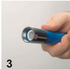
Die konisch verlaufende Innenschraube wird mit einem Inbusschlüssel in den Innenschlauch eingedreht. Gleichzeitig sollte die Aussenhülse mit einem Gabelschlüssel festgehalten werden.
