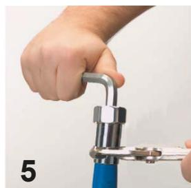
Dabei dreht sich das Gewinde der Schraube in den Innenschlauch und verquetscht den Schlauch wasserdicht zwischen Aussenhülse und Innenschraube.
