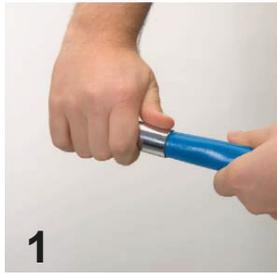
Achten Sie vor der Montage bitte immer darauf, dass der Schlauch gerade abgeschnitten ist. Die Hülse zunächst mit der großen Öffnung ausetzen und locker ausschrauben. Dabei dreht sich das Innengewinde der Hülse auf die Außenhülse des Schlauches.
